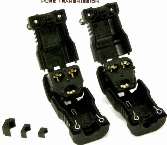
FI-15Plusの内部。結線しやすいケーブル挿入口とハウジング、新型「アースジャンパー」など、従来品と比べるとその進化の大きさが分かる。ケーブルクランプ部は、さまざまな径のケーブルに対応し、安定したグリップと共振をコントロール。安全性や作業性も大幅に高めた
