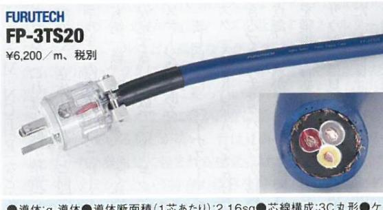
●導体:α-導体 ●導体断面積(1芯あたり):2.16sq ●芯線構成:3C丸形 ●ケーブル外径:14.3mm ●取り扱い:フルテック(株)
