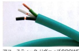
アコースティック・リヴァイブのPOWERMAX8800 (生産終了)。PCOCC-A導体を5.5スケアの極太3芯キャブタイプ構造で採用する電源ケーブル。銅箔シールドを装備し、シースは高分子ポリオレフィン
