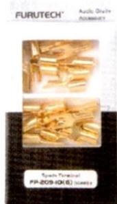
フルテックのYラグ、FP-209-10(G)(¥5,250／20個入り)。厚さ1.0mmの純銅板材に24Kメッキを施し、外寸は8W×25mm、開口寸法は4.3mm。ワイヤー適応径は最大10AWG／5.5SQmm
