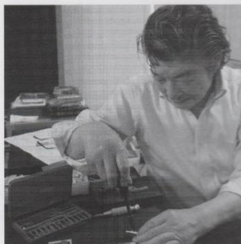
端子との接点がしっかり固定されているかが音質を左右する
