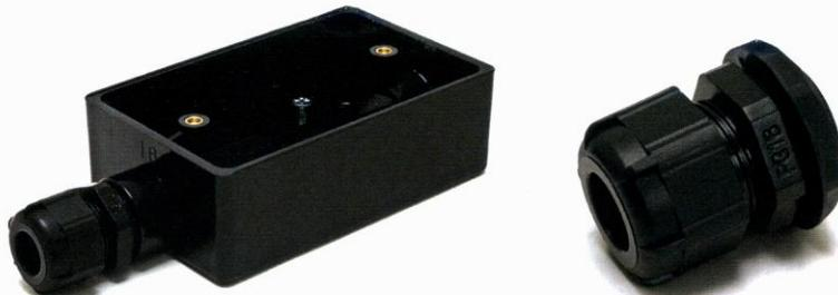
ミライ工業のブラックカラーのプラスチック(塩ビ)ボックス、PVR-16-2K(¥440、税別)に、タカチ製のクランプRPG16-14B(¥190/税別、オヤイデ電気秋葉原店での価格)を取りつけたところ。装着する時は、クランプのネジ部根元に装着されている防水仕様のOリングを外すと、より深く差し込む
