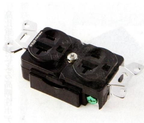
フルテック GTX-D (R) (¥17,640)。GTX Series のハイエンドグレード壁コンセント (20A 125V)、純銅のロジウムメッキ仕様。取り付け金具は 2mm の厚みを持つステンレス
