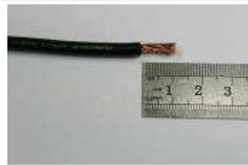
1cm 程の絶縁層を剥離して, FP-209 に挿入して下さい。
