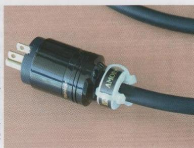
アモルメットのリングコアノイズフィルターの装着にも工夫した。電源ケーブルをリングに通したあとに、適度な本数の結束バンドをさらに通して締めつける。このようにすれば、リングがケーブル上の任意の位置に固定される
