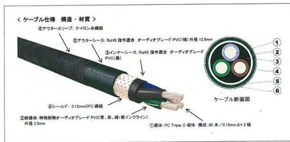
The Astoriaのケーブル構造。導体はPC Triple-C、絶縁材にはオーディオグレードPVCを採用することで、耐電圧、耐熱の向上と振動の防止を実現している
