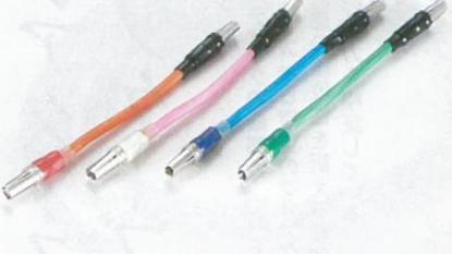
●導体：0.2mm純銀メッキα(Alpha)OCC導体7本燃り●被覆：特殊オーディオグレードPE(外径1.4mm)●導体とピンの接続：無ハンダ・圧着仕上げ●コンタクトピン：無垢燐青銅の精密削り出し、ロジウムメッキ●ピン先端部：4ポイント接触設計の特殊形状●サイズ：2.4mmφ(最大)×43mm(長さ)
