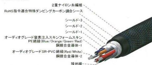
α-導体とは、銅合金、OCC導体、μ-導体、μ-OFC導体に超低温処理を始めとする独自のαProcessにて処理した導体
