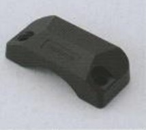
オプション「Top Clamp」(¥13,800、税別)。NCF Booster-Signalに追加し強化できる。ステンレスパウダーを基本材料とし、複数の特殊制振金属パウダーを調合、ナイロン樹脂と複合させ、質量は約295g
