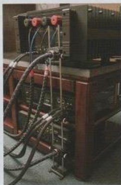
同じブランドの機器は電源端子の位置がほぼ似通った位置のため、タワー型に延長すれば共通でサポートすることも可能
