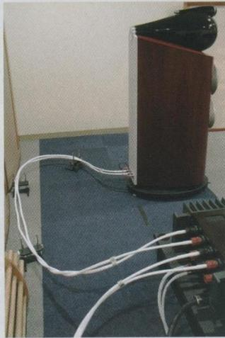
次に、NCF Booster-Signalを片chあたり3個ずつをスピーカケーブルに挿入する。ケーブルは床面から完全に浮いている。初めはベース+パー1本分の高さで試聴
