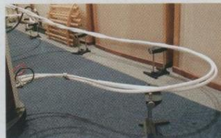
付属の延長用シャフトバーを使った2本分の高さとして、ケーブル受けのクレイドルフラットを2本目のパーの上のラインに固定して聴く
