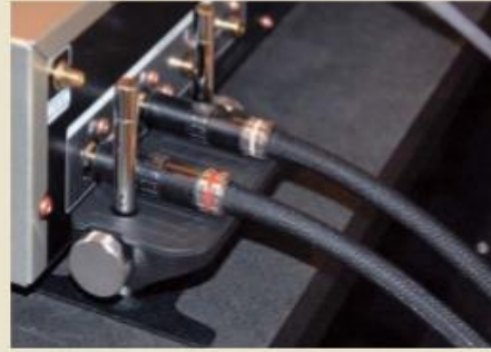
マランツのネットワークCDプレーヤーND8006の、アナログ出力端子部へNCF Booster-Signal-Lを挿入。ここは従来のNCF Booster-Signalは使えなかった場所だ
