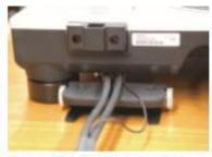
プレーヤーから信号出力されるフォノケーブルを、NCF Booster-StanesLを用いてプレーヤー直近の位置で支える
