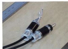
②ケーブルはシアフトンのSC-HR1500を2cmにかっこしたもの。日本車業。スピーカー端子端にR2Yラグとバナナプラグは、フルテックのCF-201 (R) とCF-202 (R) を用いた
