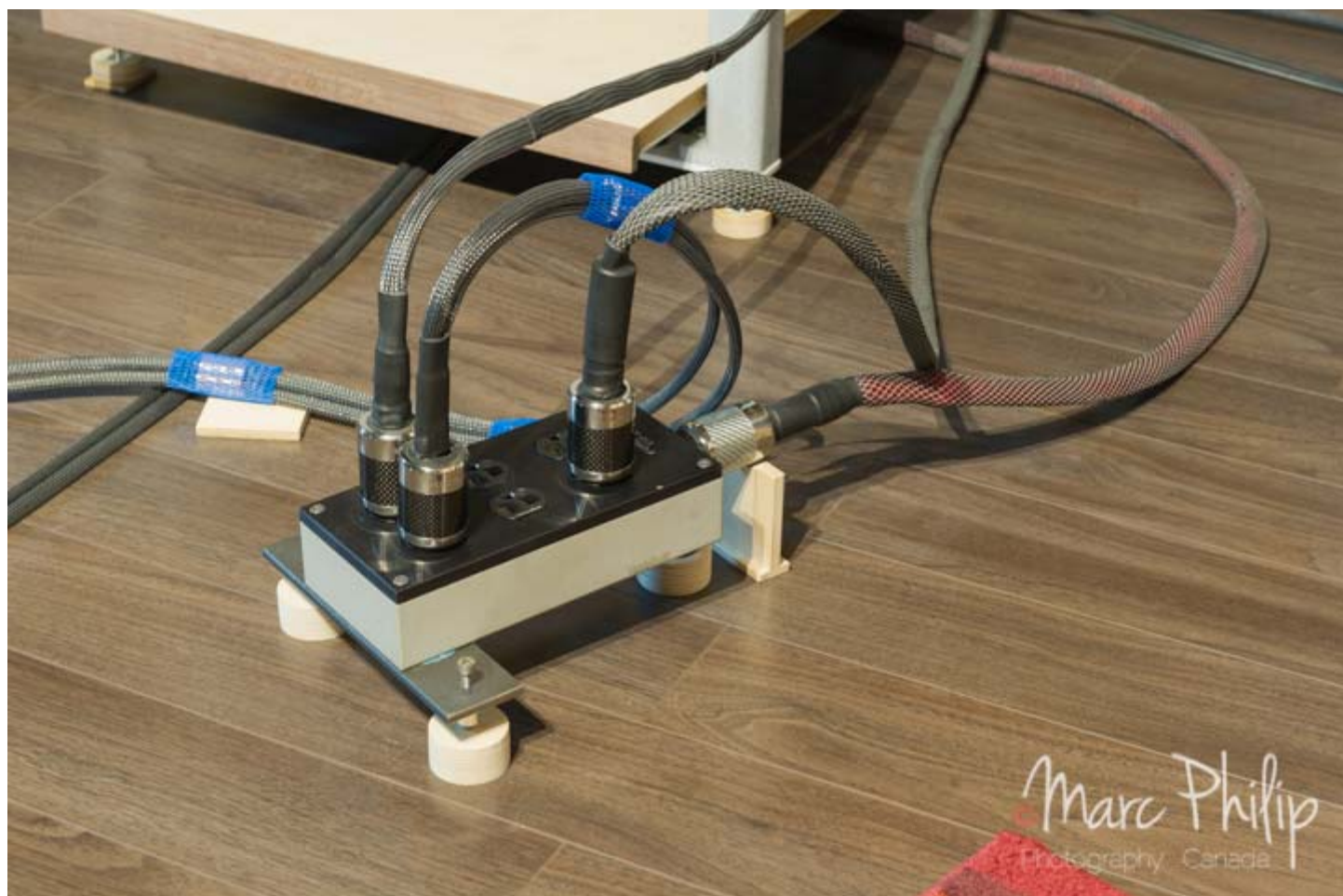
Boîtier de distribution multi-prises Furutech RTP-6 et cordon AC monté avec des connecteurs NCF
