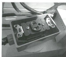
出水電器のパワーアンプ、アリオンM-300の電源ケーブル用にGTX-S NCF(R)を使用している(田中)
