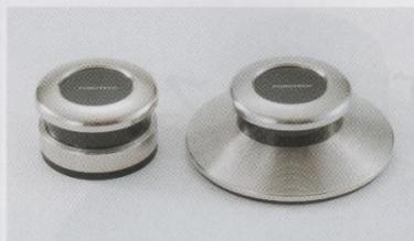
Monaco LP Stabilizer(左)とMonza LP Stabilizer(右)。いずれも非磁性体ステンレスブロックの精密削り出し、制振効果の高いカーボンファイバー仕上げの2段構造。ディスクのみならずターンテーブルの振動をも効果的に吸収できる
