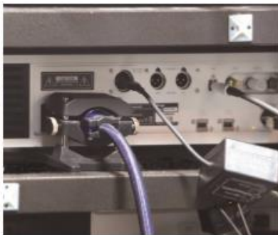
NCF Boosterを、オーレンダーのネットワークトランスポートW20の電源インレット部に装着して継続使用中
