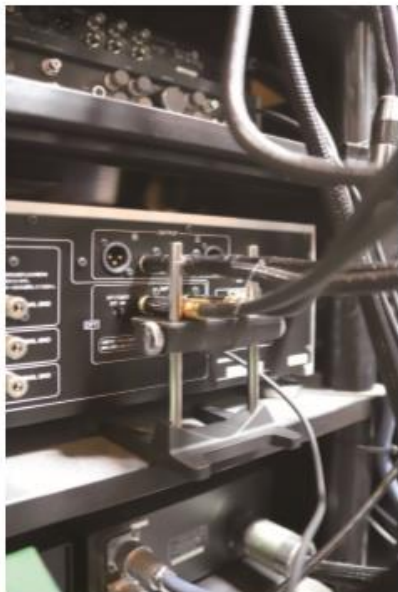
ソウルノートのオールインワンフォノイコライザー、E-2の入出力端子部にNCF Booster-Signalを装着
