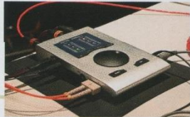
マイクプリでADした信号はMADI伝送でモニタリングルームへ。MADI信号はRME MADIFace Proで受信。本体下にシックスエレメントのシート状アクセサリーを設置。PCとの接続はクリプトンのUSBケーブルUC-HRを使用。モニタリング用のバランスケーブルはナノテックスシステムズ Music Strada #208を使った自作品を用いた
