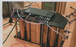
マイクプリアンプ及びA/DコンバーターにはRME OctaMic XTCを使用。本体天板にはシックスエレメントのシート状アクセサリーを配置して機材のポテンシャルを最大限に発揮させる。また、各種ケーブルのコネクター部にはフルテックNCF Boosterを用いて信号経路をケア
