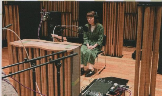
2人の間には、吸音パネルを挟んで大型の床用ANKHを2台設置して、遮音と拡散効果を狙っている。また、乾さんを取り囲むように3台のSYLVANを設置。有りと無し状態で録音し比較したところ、SYLVANを追加で設置した方が、歌声がより生き生きとした表情になった。収録曲2曲は、それらAGSのみによるアンビエンスがそのまま収録されており、リヴァーブなどの残響エフェクトは一切使用していない
