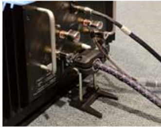
パワーアンプへの装着は、2本付属されているエクステンションシャフトバーを支柱に追加して使用した
