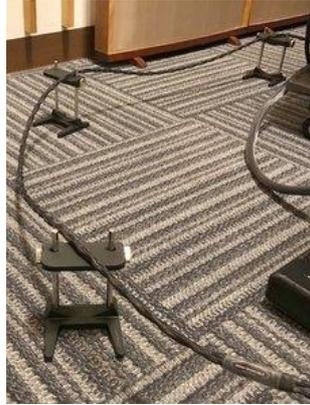
床面にスピーカーケーブルが接触しないよう、複数個使用
