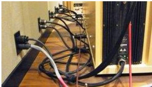
電源系のケーブルと信号系のケーブルを効率良く分離し、そして理想的な環境を整える
