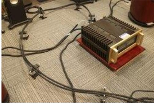
インターコネクトケーブルを完全に浮かせて、床からの影響のみならず、他のケーブルとの交差も接触せず立体的に配線することができる
