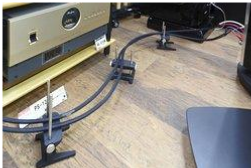
バイワイヤリングのスピーカーケーブルに装着した「NCF Booster-Signal」
