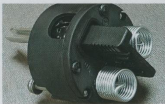
「NCF Clear Line」の内部。エアコイルはα (Alpha) OCC単結晶銅導体エナメル線に「2段階～超低温処理および特殊電磁界処理～α-Process アルファプロセス」を採用。外層は高性能シルバーカー特殊制振塗料コーティングで振動を抑制
