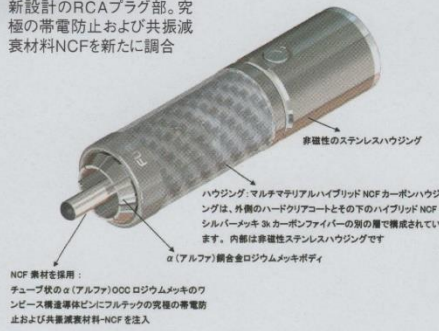
ワンピース Alpha OCC 導体構造拡大図
