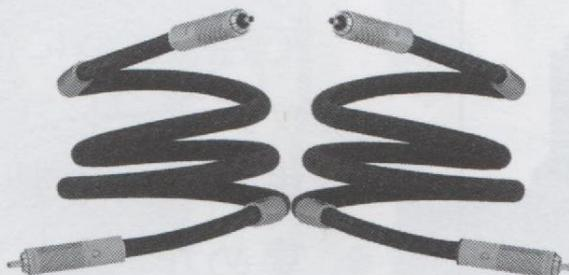
その周囲に高級ポリエステル誘電・絶縁材を配し、 $\alpha$  導体編組とアルミPETテープによる二重シールドと、共振減衰材料のナノセラミック／カーボンパウダーコンパウンドを配合したPVCシース、ナイロン糸編組ジャケットを用いる。新開発のロジウムメッキプラグCF-102 NCF (R) は、チューブ状の  $\alpha$ -OCC 一体構造導体ピンと  $\alpha$  銅合金ボディ、NCF+銀メッキ3kカーボンファイバー層を加えた非磁性ステンレスハウジングで構成される。導体は、ネジどめ結線方式を採用。
