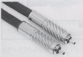
RCAプラグに新開発のCF-102 NCFを採用。プラグの後ろにステンレス筒を取り付けてケーブル表面の振動をダンブしている
