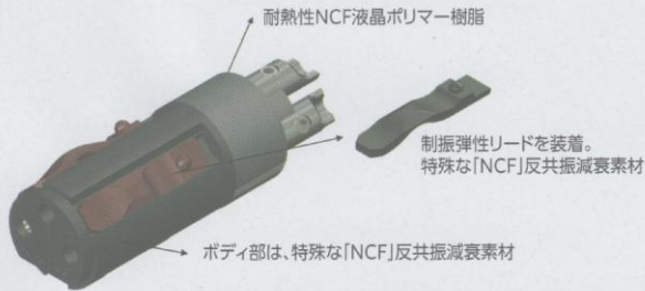
耐熱性NCF液晶ポリマー樹脂 純銅素材のα(アルファ)-導体 ロジウムメッキのワンピース構造の導体 非磁性のステンレス鋼 六角穴付き止めねじ 特別に設計された、ネジ止め またはハンダによる結線 ボディ部は、特殊な「NCF」反共振減衰素材 純銅素材のα(アルファ)-導体ロジウムメッキのワンピース 構造の導体ピンに、耐熱性NCF液晶ポリマー樹脂を充填
