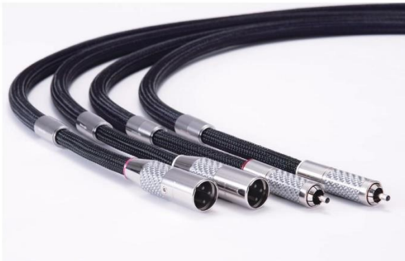
NCFを採用の最新モデル「Lineflux NCF (RCA) / (XLR)」。新開発RCAプラグ「CF-102 NCF (RCA)」と、XLRプラグ「CF-601M NCF (R)」(オス)「CF-602F NCF (R)」(メス)は単売もされる。導体ピンはいずれもロジウムメッキ。XLRプラグがネジとハンダの両方の結線に対応する点も注目
