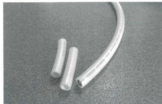
ケーブルを固定するスリーブとして、外径10mmのケーブルを探し外皮を利用した
