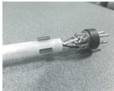
③3芯シールドでは細いシールドのドレイン線があるのを注意。この線は送りもとのアース端子にアース線と一緒に接続。送り先側は接続しないでシールドは片接地にする
