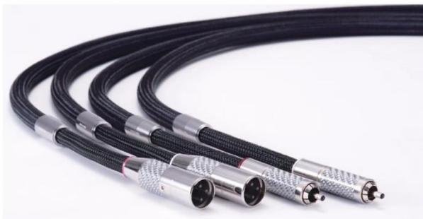
最新モデル「Lineflux NCF(RCA) / (XLR)」。新開発RCAプラグ「CF-102 NCF(RCA)」と、XLRプラグ「CF-601M NCF(R)」(オス)「CF-602F NCF(R)」(メス)は単売もされる。導体ビンはいずれもロジウムメッキで、先端の黒い部分は、注入された耐熱性NCF液晶ポリマー樹脂。RCAプラグはもちろん、XLRプラグも、ネジハンダの両方の導体結線に対応している
