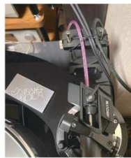
トーンアームケーブルをフルテック「NCF Booster-Signal-L」(¥17,908、税込)で支え、付属のバンドで密着固定
