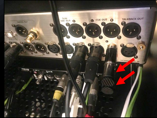
スタジオモニターコントローラー アナログ アンバランス入力側 L/R端子へ
