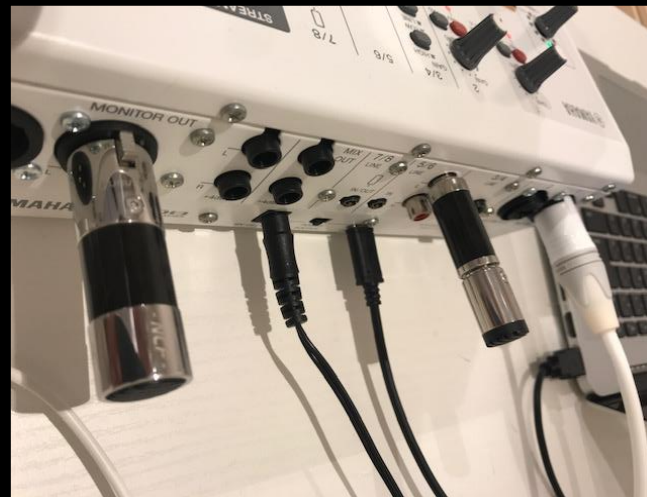
ライブストリーミングミキサー モニター 出力側L端子へ
