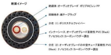
「Project V1-L」のケーブル断面図
